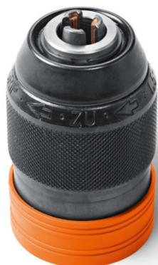
Bucha de fixação totalmente metálica da marca Röhm com mordente de fixação de metal duro e elevadas forças de aperto. O bit de parafusamento pode permanecer no veio de acionamento, a bucha de fixação passa por cima do bit. Torque máximo 120 Nm. Compatível com todas as parafusadeiras sem fio FEIN com interface QuickIN/QuickIN MAX.
