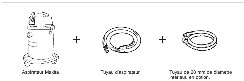
Pour le raccordement à l'aspirateur Makita (modèle 420), le tuyau en option n'est pas nécessaire. Vous pouvez raccorder la ponceuse à bande directement au tuyau du collecteur de poussière.
