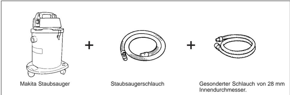
Zum Anschließen an den Makita Staubsack (Modell 420) wird der gesonderte Schlauch nicht benötigt. Der Bandschleifer kann direkt an den Schlauch des Staubsacks angeschlossen werden.
