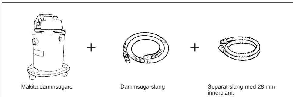
Vid anslutning till en Makita dammuppsamlare (modell 420) behövs inte den separata slangen. Du kan ansluta bandslipmaskinen direkt till dammuppsamlarens slang.
