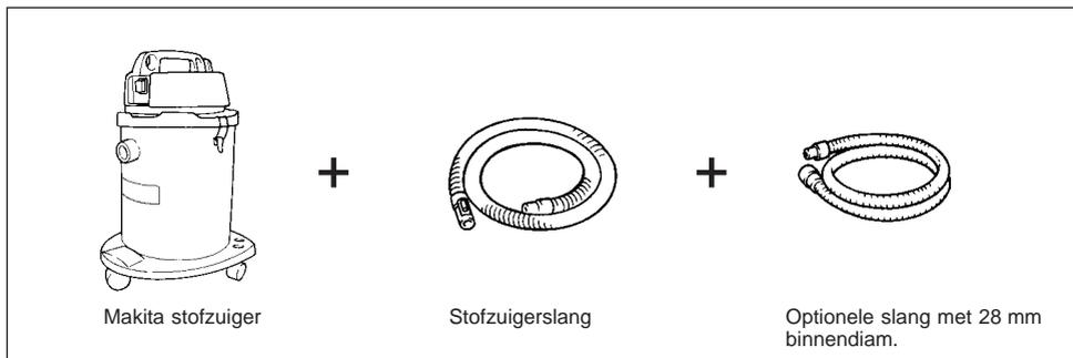
Om aan te sluiten op de Makita stofvanger (Model 420), is de optionele slang niet nodig. U kunt de bandschuurmachine direct aansluiten op de slang van de stofvanger.
