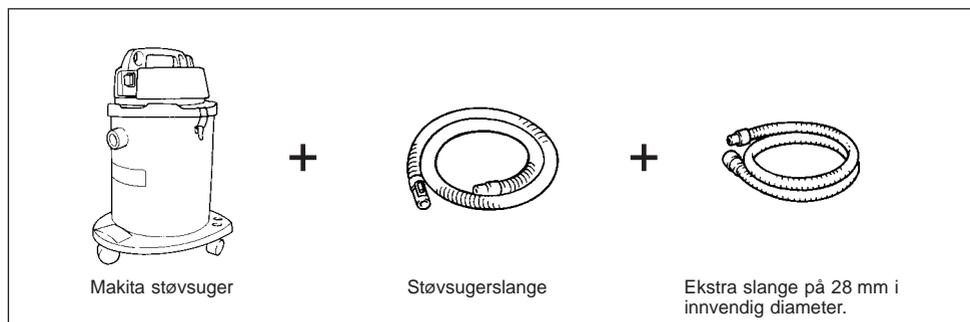
Ved tilkopling til Makita støvsamler (Modell 420), er den ekstra slangen ikke nødvendig. Båndsliperen kan koples direkte til slangen på støvsamleren.
