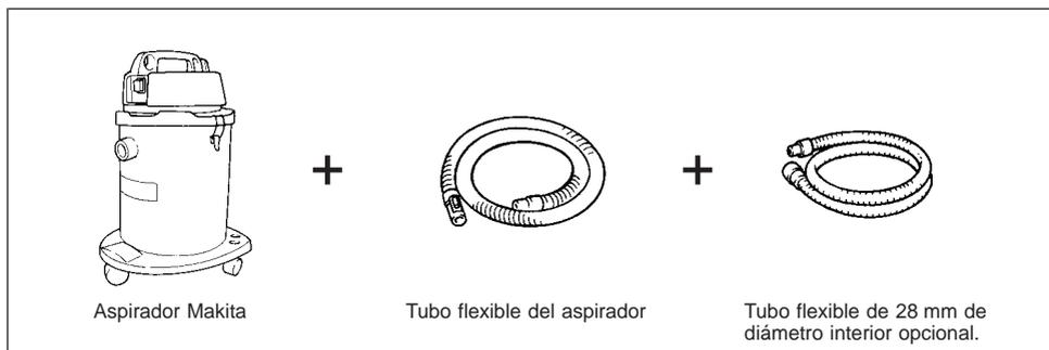
Cuando conecte el aspirador de polvo Makita (Modelo 420), no necesitará el tubo flexible opcional. Podrá conectar la lijadora de banda directamente al tubo flexible del aspirador de polvo.
