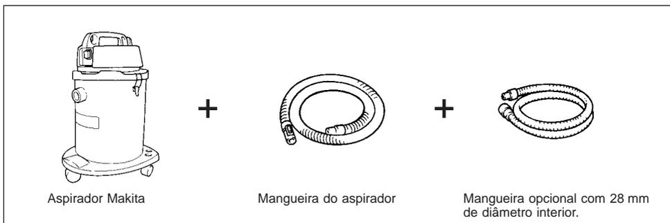
Quando liga ao aspirador Makita Modelo 420 não necessita da mangueira opcional. Pode liga a lixadora de braçadeira directamente à mangueira do aspirador.
